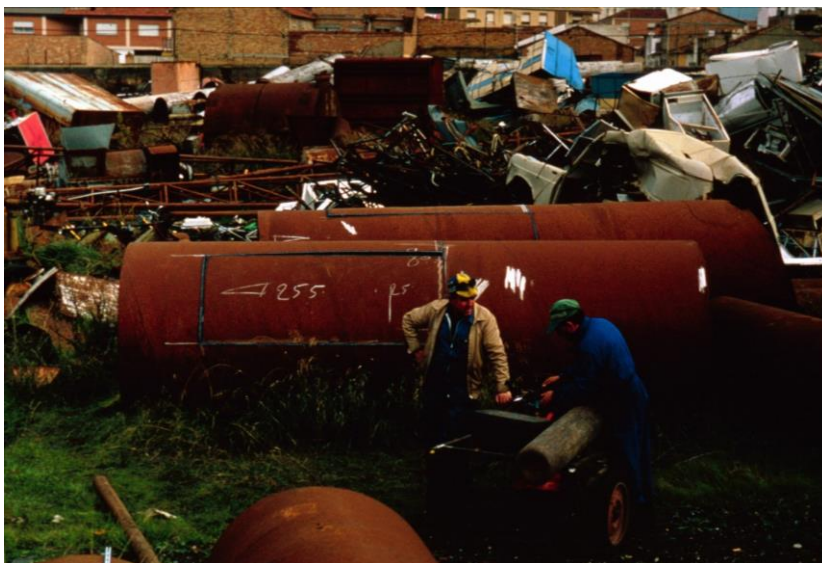
Tubería de acero cortén del trasvase Huelva-Cádiz en un vertedero y transformado en probador.
